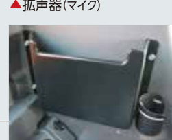
▲マガジンラック& ドリンクホルダー(L/R)& アクセサリソケット(L/R)
