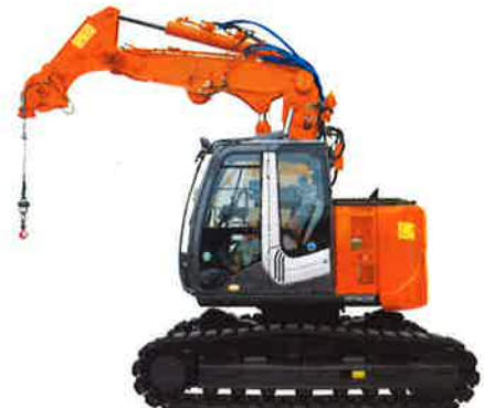
※RX1350 ショートアーム仕様およびフラットシューなどオプション装着機
