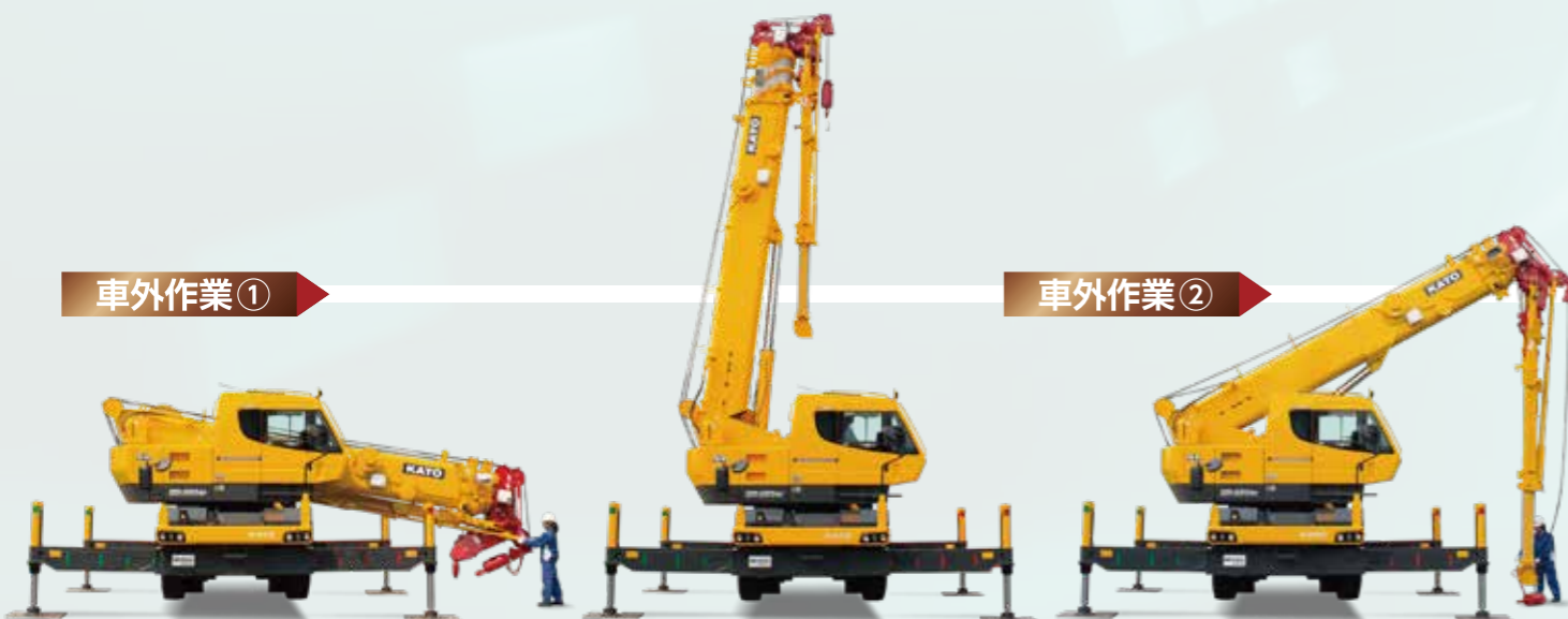
ブームをスラントさせ、低位置でテンションロッドを接続する。
